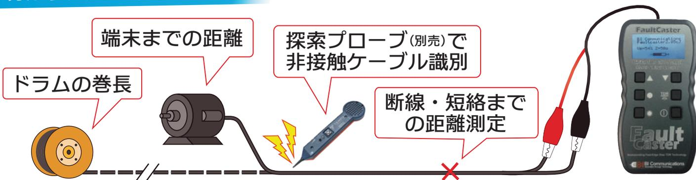
〈寸法/重量〉90W×186H×37Dmm/350g 〈電源〉リチウムイオン充電電池(内蔵) 〈測定距離〉2000m 〈精度〉±2%
