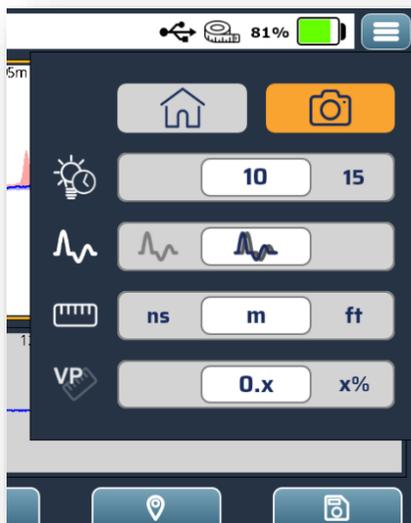
他の波形がメモリにロードされていない場合は、左に示すように、「ライブトレース」モードと「断続的」モードのオプションのみが表示されます。
