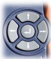
中央のボタンは、画面上でハイライト表示された項目の「入力」または「選択」ボタンとして機能しますが、「TDR」テストウィンドウでは、「詳細」波形と「概要」波形の間で「ハイライト」を切り替えます。「詳細」波形または「概要」波形が有効な場合、4つのカーソルキーは異なる機能を提供します。
