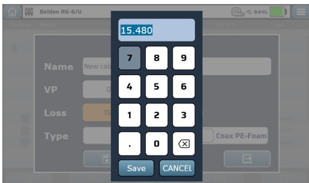
ケーブルの「500MHzにおける100mあたりの損失」を入力します。この情報はメーカーのデータシートで確認できます。これは、「イベントリターンロス」を正確に計算し、自動イベント検出機能が適切に機能するために必要です。数値はデシベル単位で入力して選択するか、「保存」をタップします。
