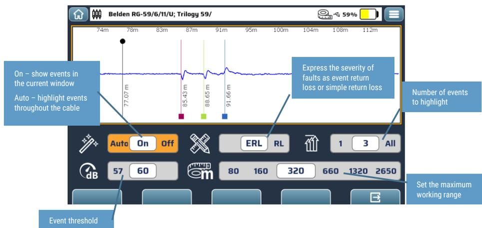
イベント検出を動作させるには、「オン」または「自動」に設定する必要があります。「オン」の場合、自分で選択した可視ウィンドウのイベントのみが強調表示されます。「自動」に設定すると、選択した動作範囲まで、ケーブルの全長でイベントが強調表示されます。
