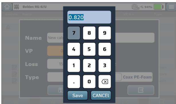
ケーブルの「伝播速度」Vpを入力します。これは、光速係数 0.xxx の形式で行う必要があります。数字 xxx を入力するだけでよく、ゼロは暗黙的に含まれます。 選択して入力するか、「保存」をタップします。
