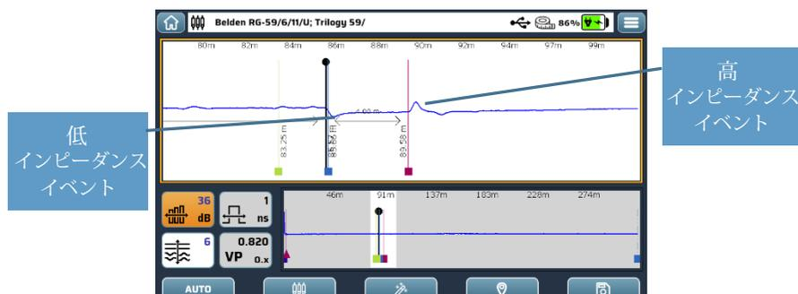
TDR は、水平 (x) 軸に沿って時間とともにテストされたケーブルのグラフを表示します。オプションで距離に変換できます。
