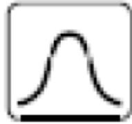
ピークモードは、目的線の直上で最も強く反応します。
