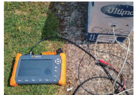
ケーブルの残量を測長
